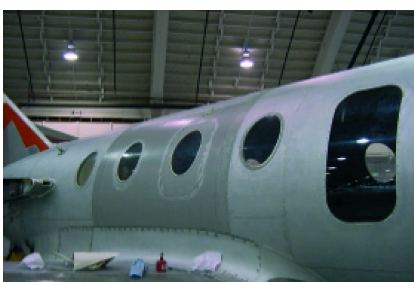
Carlingue d'avion traitée par la solution de décapage écologique Sofiplast
