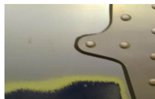
Les surfaces sont décapées jusqu'à la couche souhaitée et sont prêtes à être traitées.
