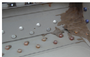
Décapage de joint PR. Les déchets sont triés et les médias réutilisés.
